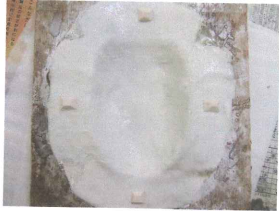
* シリコンゴムによる内型の作製
