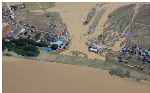
堤防決壊による家屋の流失(鬼怒川)
