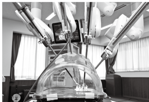
4本のロボットアームが術者の手指に連動 ※写真はデモ機
