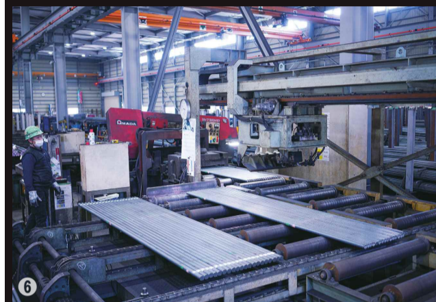
1 森の里東に建設した約5千平方メートルの工場 2 鉄筋を切断する今村さん 3 同僚や実習生と昼食をとる今村さん(中央) 4 手入れされた工具 5 鉄筋の曲げ加工 6 1メートル単位で鉄筋を切断する精密切断機 7 加工長と打ち合わせをする森工場長(左) 8 10メートルまで吊り上げられるクレーン 9 3メートルの鉄筋を台に乗せる今村さん 10 完成した鉄筋の製品。さまざまな型がある
