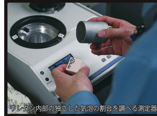
ウレタン内部の独立した気泡の割合を調べる測定器
