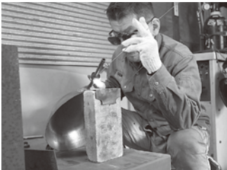
ガスを使った溶接で部品をつなげる
