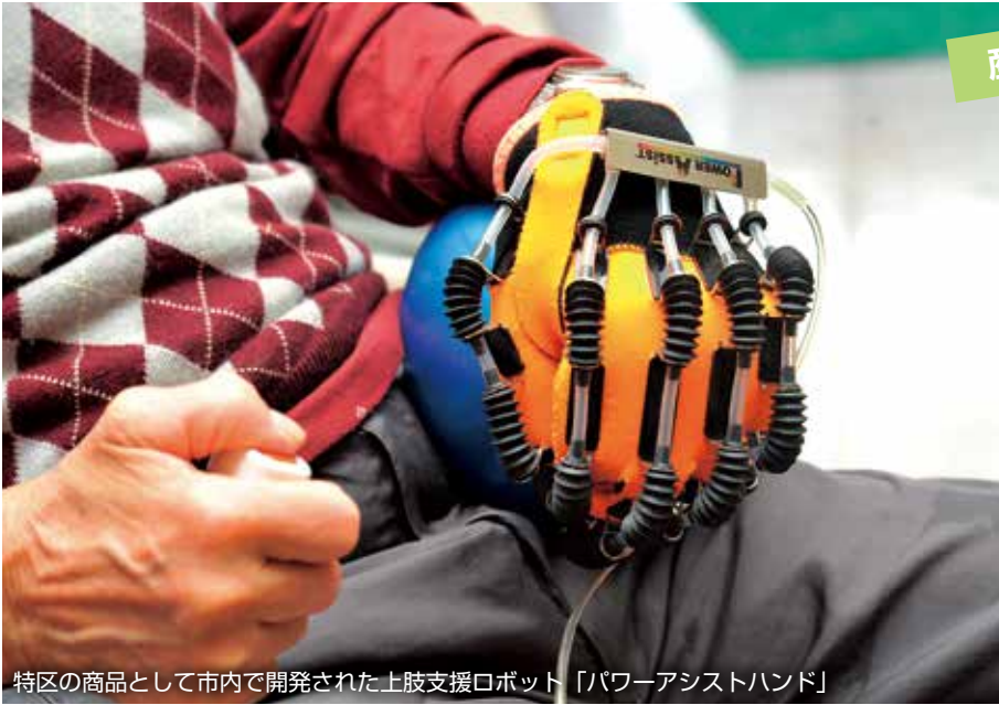
特区的商品として市内で開発された上肢支援ロボット「パワーアシストハンド」
