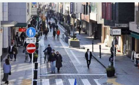
道路内に駐車スペース、クランク、などを設け、自動車の速度抑制
