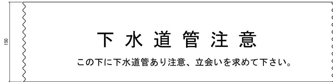
注 1) 明示シートは管基礎（管防護）層上部に連続して敷設する。
