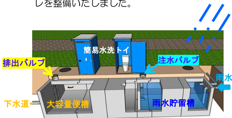
図 3-8 災害用トイレシステム概略図
