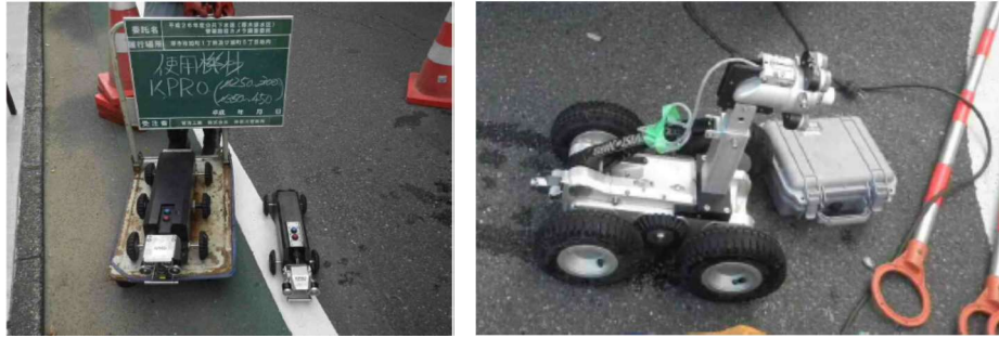
写真3-9 管きよ内TVカメラ調査車
