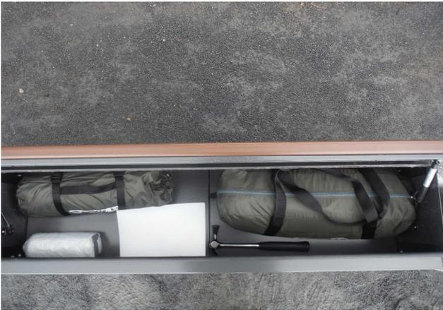
③中にトイレ用テント、ピン固定用ハンマー、取扱説明書（トイレスツール、テント組立手順等）、トイレ用トイレットペーパーが収納されています。
