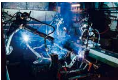
溶接ロボット
