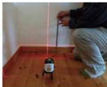
「床の傾きを計測する」調査機器
