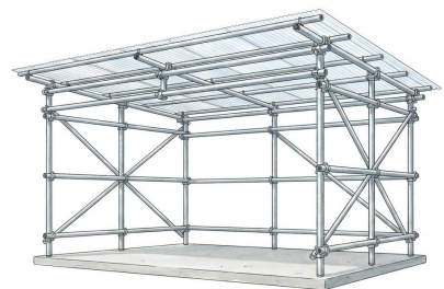
単管パイプ組 屋根かけ
