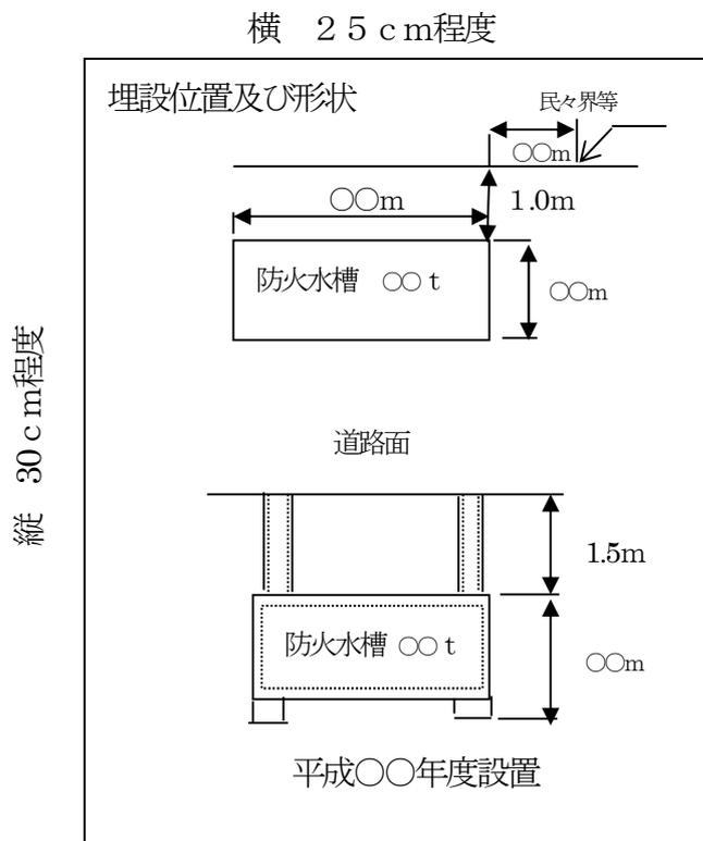
設置部分は、防火水槽標識裏面とし、標識設置箇所による裏面設置ができない場合又は設置後明示板が確認できなくなるおそれのあるときは、別途協議すること。
