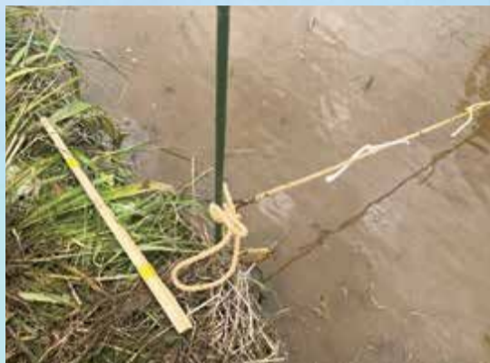
30センチメートル間隔の目印を示すひもの設置
