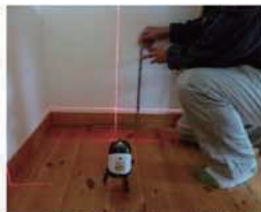
「床の傾きを計測する」調査機器
